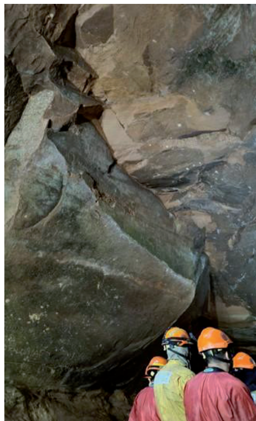
Foto 3. Vista do maciço rochoso, grau de faturamento e a possibilidade de formação de blocos ou lascas.
