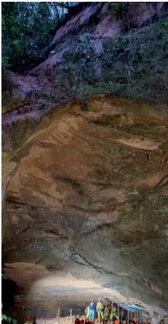
Foto 4. Vista geral do local do acidente, com destaque para as marcas no teto da gruta, recém afetado pela ruptura.
