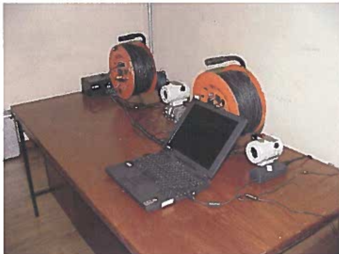
Foto 1 - Conjunto de aquisição de dados Hart e processamento on-line .
