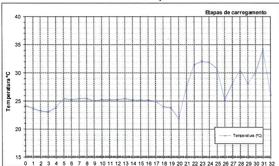
GRÁFICO 1.1 PROVA DE CARGA - EDIFICAÇÃO 2 EXTREMIDADES DOS BALANÇOS - VÃOS 2-3 e 3-4
