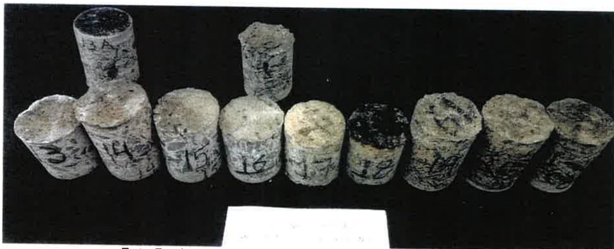
Foto 7 – Aspecto dos testemunhos extraídos da Edificação 5.
