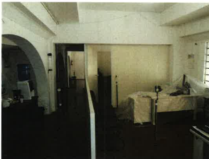
Figura 31 – Instrumentação instalada no interior do cômodo, para medida dos deslocamentos da arquivancada – Defletômetros D9 a D14.
