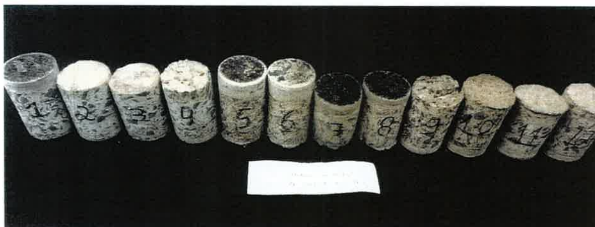
Foto 5 – Aspecto dos testemunhos extraídos da Edificação 2
