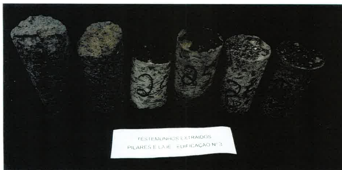
Foto 6 – Aspecto dos testemunhos extraídos da Edificação 3
