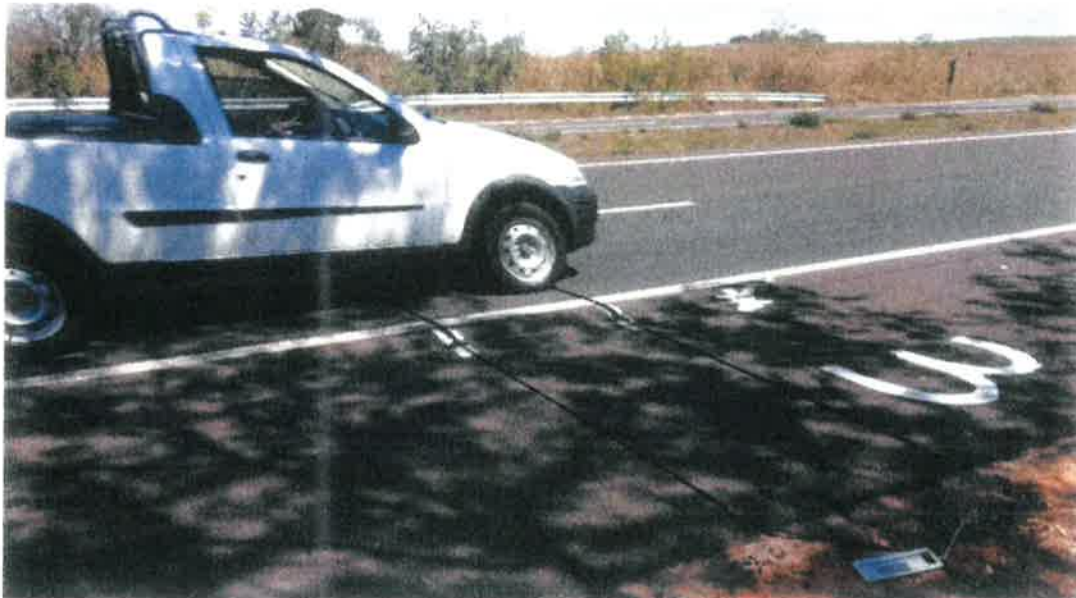
Figura 9 – Equipamento de Contagem Volumétrica automática em operação
