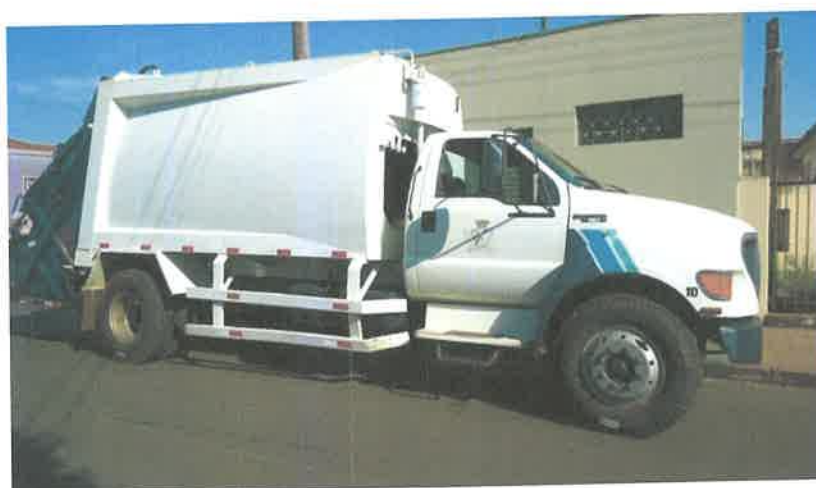
Caminhão Compactador Coletor dos resíduos domiciliares, comerciais e limpeza urbana.
